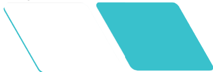
Figura 1 LIQOSEAL® con una capa de espuma blanca adhesiva y una capa sellante azul; esquema
