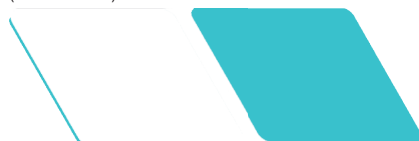
Rysunek 1 LIQOSEAL® z białą warstwą przylepną i niebieską warstwą uszczelniającą – schemat
