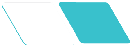
Figura 1 LIQOSEAL® com uma camada de espuma branca adesiva e uma camada obturante azul – desenho esquemático
