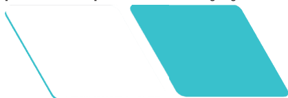
Abbildung 1 LIQOSEAL® mit einer weißen klebenden Schaumschicht und der blauen Dichtungsschicht - schematische Darstellung
