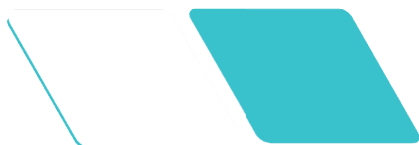
Afbeelding 1 LIQOSEAL® met een hechtende witte schuimlaag en een blauwe afdichtende laag - schematische tekening
