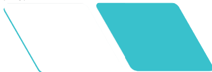
Figur 1 LIQOSEAL® med ett vidhäftande vitt skumlager och ett blått förseglande lager - schematisk ritning
